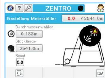
Anzeige der gewickelten Gewebemeter, Alarm-Funktion bei Erreichen der Stüklänge
